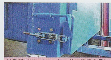
⑦側部ドアストッパー: ドア接続金具に 続くアオリを強固に離さない三重目 のロック。
